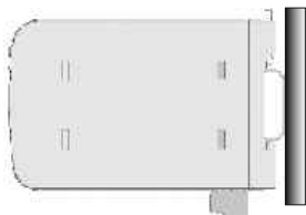
Rys. 3 Montaż na szynie TS-35 (DIN)
